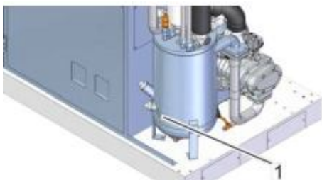
Рис. 30: Проверка уровня охлаждающей жидкости с помощью смотрового стекла
